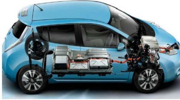
Şekil 7. Elektrikli Araca yerleştirilen bir batarya hücresi örneği
