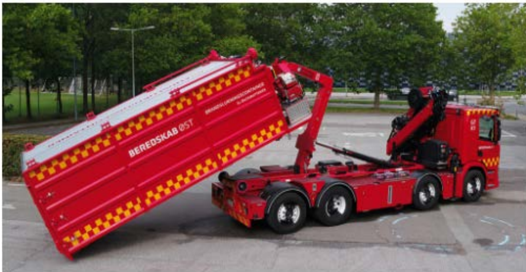
Şekil 25. Elektrikli Araç yangınları için tasarlanmış konteyner örneği
