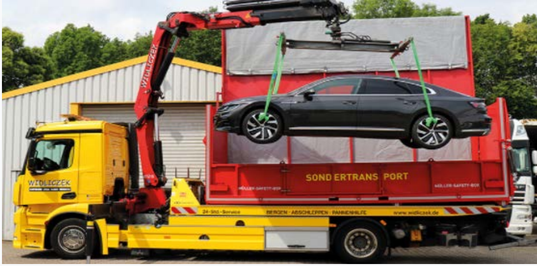
Şekil 26. Elektrikli Araç yangınlarına müdahale yöntemlerinden su dolu konteyner örneği
