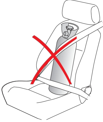
Arkada gevşek gaz tüpleri TAŞIMAYIN Silindirleri
