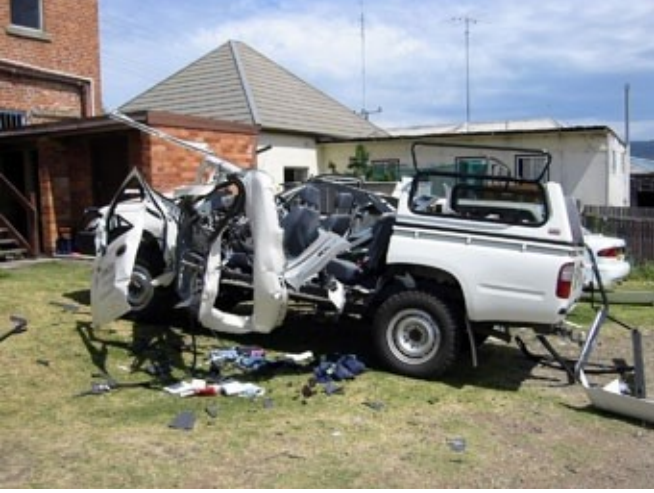
Sızıntı yapan yanıcı gaz tüpünün neden olduğu araç patlaması
