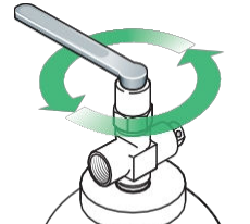
Anahtar işletim valfini açmak için saat yönünün tersine çevirin. (Kapatma gösterilmemiştir).
