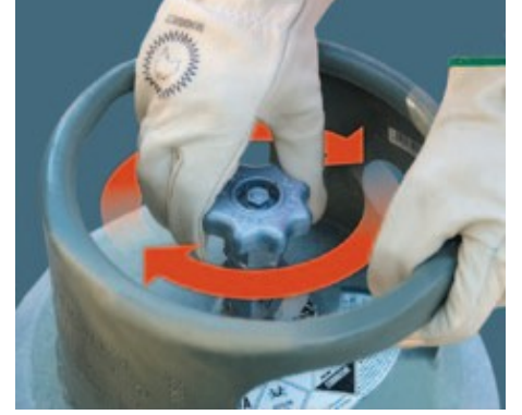
Ekipmanı hareket ettirmeden veya bağlantısını kesmeden önce silindir vanasının kapalı olduğundan emin olun
