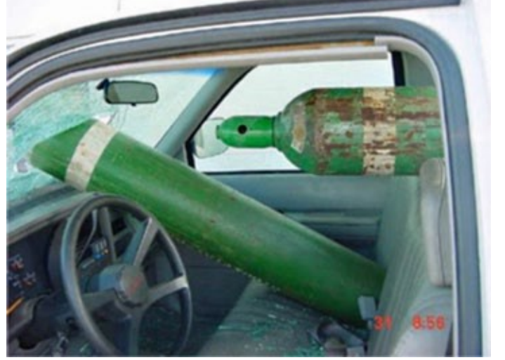
Aniden duran bir araçta uygunsuz şekilde depolanmış ve emniyete alınmamış silindirlerden kaynaklanan hasar. Lütfen dikkat: Resim sadece açıklama amaçlıdır. Silindir renkleri Avustralya Standartlarına uygun değildir.
